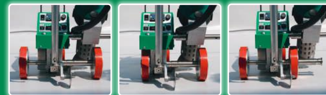
Utilisation standard : galets de roulement gauche et droit retirés
